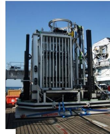
海底着床型掘削装置 (海底面50mの掘削が可能)
